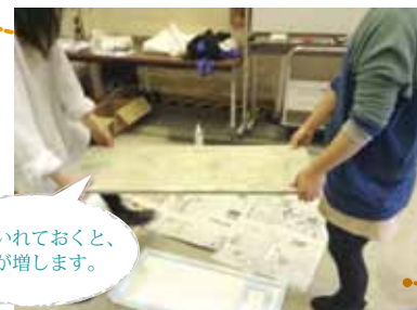
step3: 水中養生後、脱型
