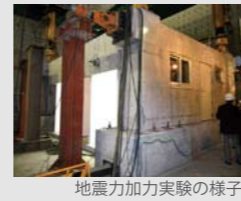
地震力加力実験の様子
