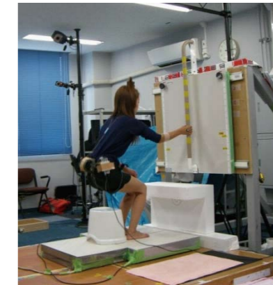
浴室での立ち座り動作実験の様子 (於：建築研究所ユニバーサルデザイン実験棟)
